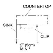
\*ALLOW CLEARANCE AROUND SINK RIM FOR CLIP ATTACHMENT.
