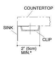
\*ALLOW CLEARANCE AROUND SINK RIM FOR CLIP ATTACHMENT.
